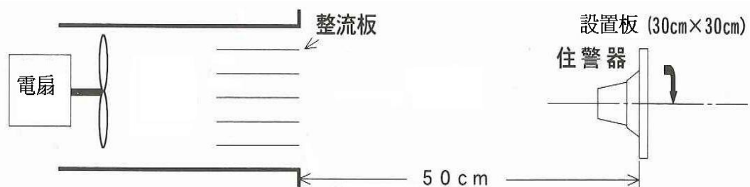
圖 1. 氣流試驗裝置圖例
