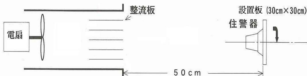
圖 1. 氣流試驗裝置圖例
