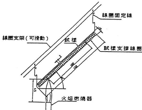
附圖五 試體支撐線圈
