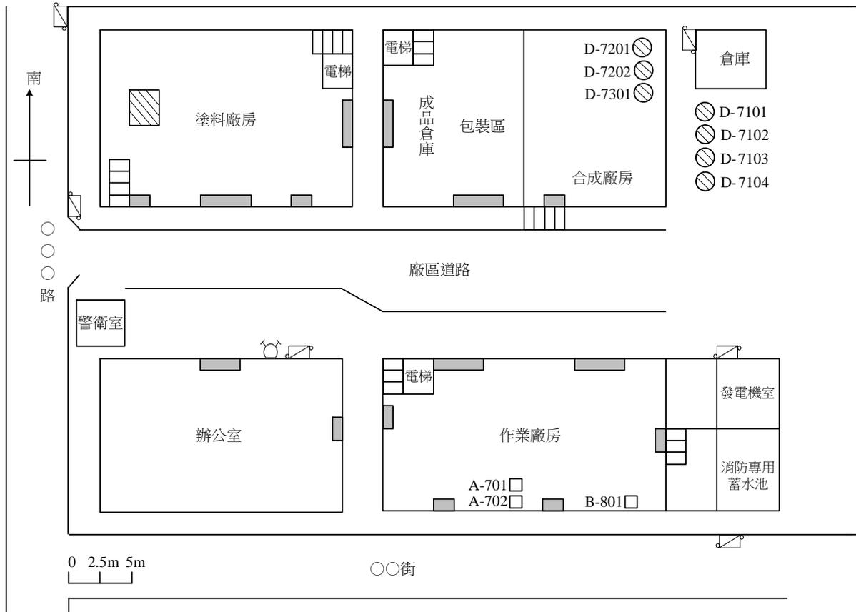
圖例： ■ 緊急出口 □ 安全梯 ◡ 室外消防栓 ◡ 連結送水管送水口
